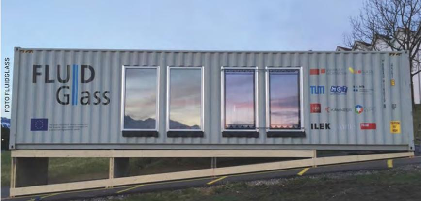
Nel telaio di Fluidglass sono alloggiati due circuiti idronici che fanno circolare il fluido termovettore: in condizioni ideali, il prototipo produce fino a 1 kW termico ogni ora. ■ pag 54
